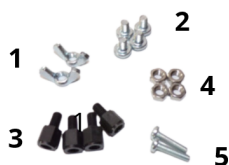
1- dwie nakrętki motylkowe M6, 2- cztery śruby M6x8, 3- cztery izolatory dystansowe z tworzywa, 4- cztery nakrętki M6, 5- dwie śruby M4x18
